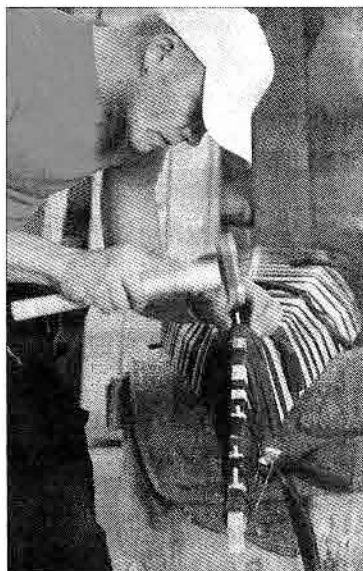
Mit Holznägeln befestigt Zimmermeister Knut Holger Badalus die Kieleiste am Rumpf.
