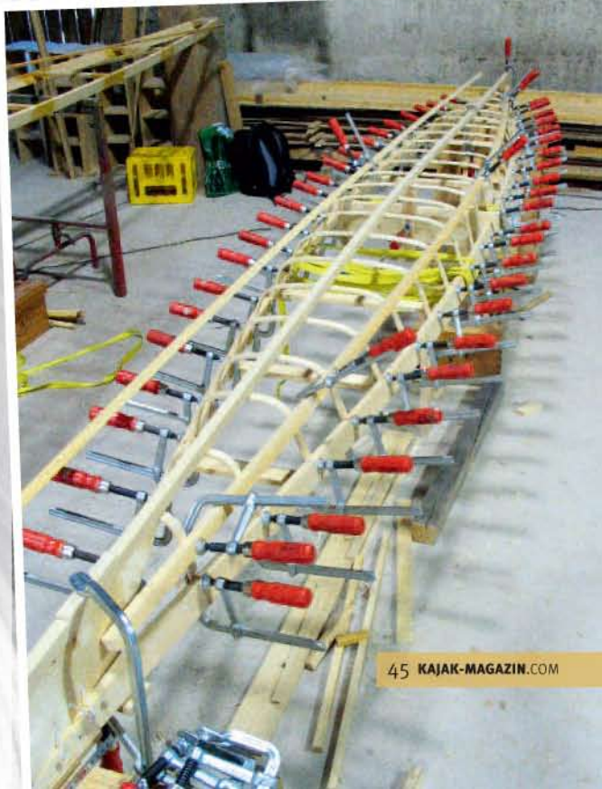
Alle Spanten sind gebogen und positioniert (unten).
