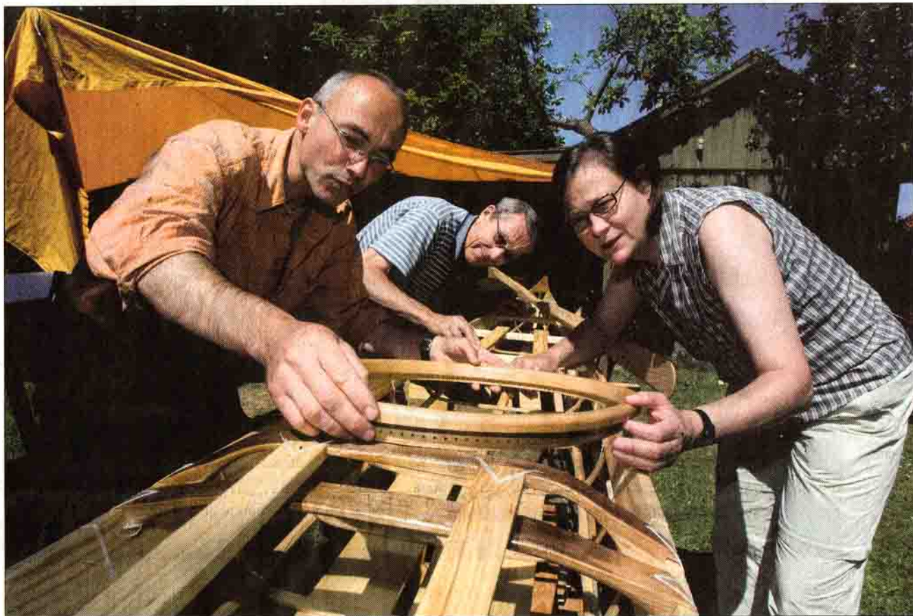
Thomas Grögler (t.v.) og Erna Haueter-Jansen og hendes far er ved at lægge sidste hånd på skelettet til kajaken. Den er lavet efter Ernas vægt, højde, bredde og armlængde. Asketræet kan først bøjes efter dampning.
