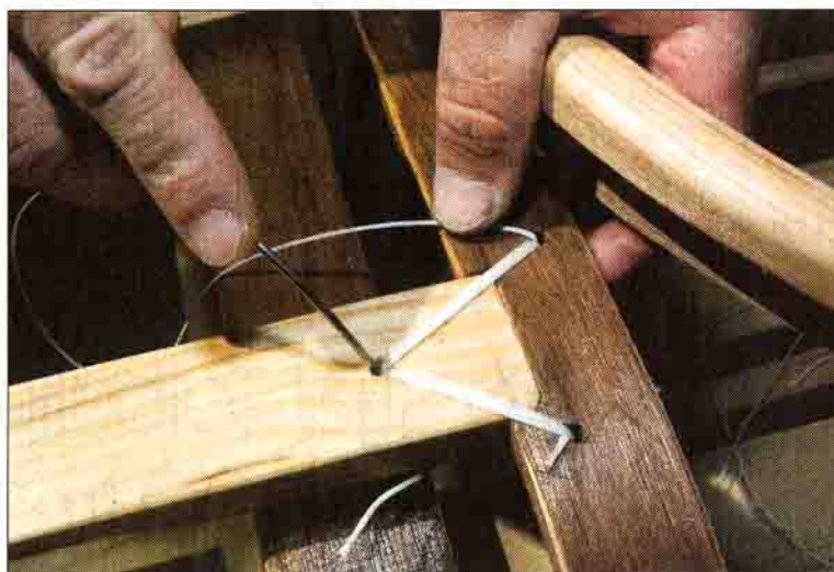
Thomas Grögler (t.v.) og Erna Haueter-Jansen og hendes far er ved at lægge sidste hånd på skelettet til kajaken. Den er lavet efter Ernas vægt, højde, bredde og armlængde. Asketræet kan først bøjes efter dampning.
